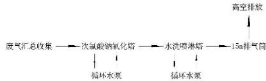
图 4-1 废气处理工艺流程简图
